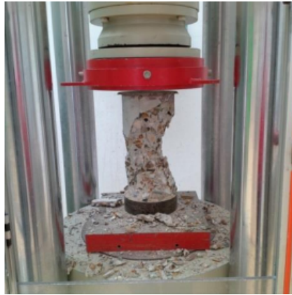
Figura 26 – Ensaio de compressão uniaxial para determinação do módulo de Young (extraído de Razafinjato (2015)).
