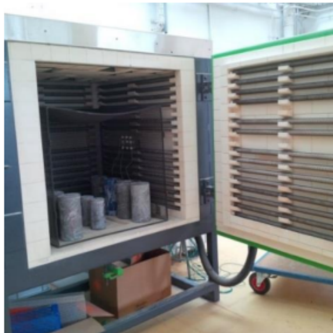
Figura 25 – Processo de aquecimento dos corpos de prova (extraído de Razafinjato (2015)).
