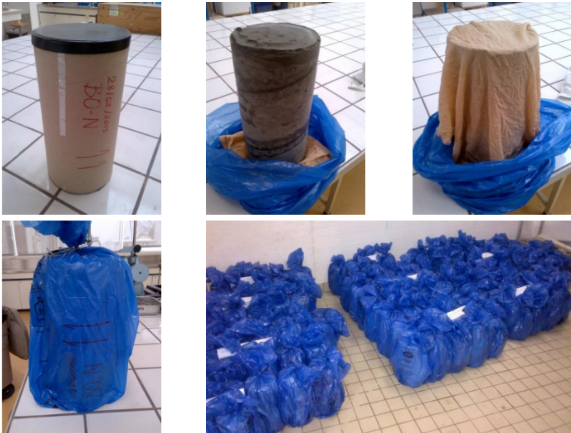
Figura 24 – Processo de produção dos corpos de prova (extraído de Razafinjato (2015)).
