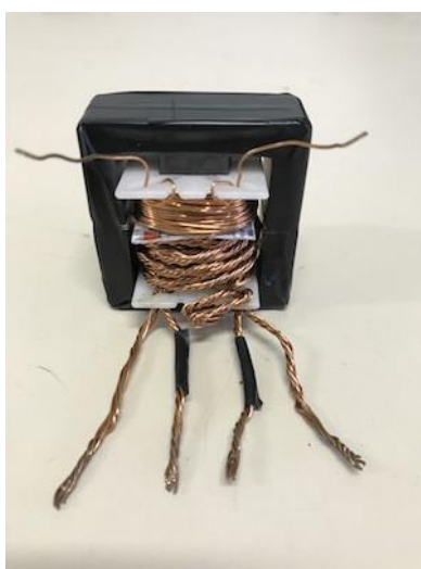
Figura 36 Fotografia do protótipo do transformador de alta frequência utilizado no projeto.
