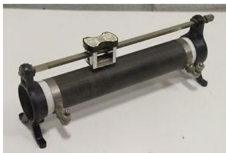
Figura 44 Fotografia do resistor utilizado como carga no modo direto.
