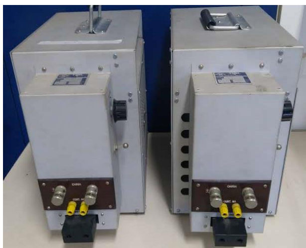
Figura 46 Fotografia do resistor utilizado como carga no modo reverso.
