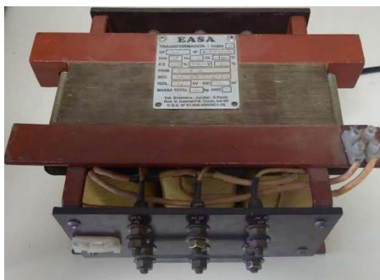
Figura 42 Fotografia do transformador trifásico utilizado para elevação de tensão para saída em 380V.
