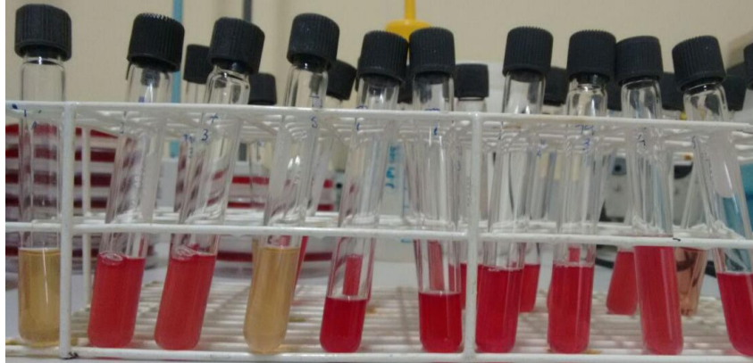
Figura 10. Teste de Voges Proskauer. Amostras em amarelo: resultado negativo. Amostras em vermelho: resultado positivo. Fonte: Francielly Ávila.
