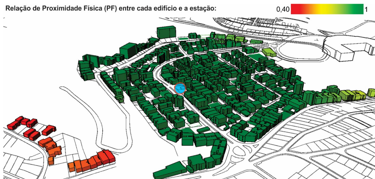
Figura 60. Relação de Proximidade Física entre os edifícios do bairro e a estação (em azul), cuja localização foi indicada por meio de otimização. Cada edificação se encontra preenchida por uma cor que corresponde ao seu índice de PF para a estação. Fonte: O autor.
