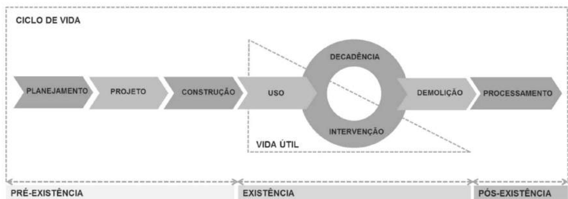
Figura 5 - Relação entre vida útil e ciclo de vida da construção. Fonte: FONTENELLE (2016).
