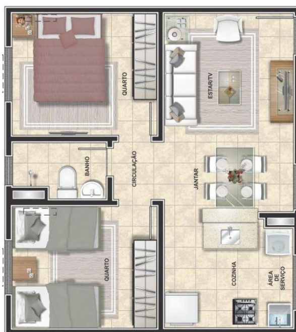
Imagem 4: Exemplo de planta baixa, recortada pela autora, de um apartamento que pode ser subsidiado pelo MCMV, com 44,09 à 48,47 m 2 . Fonte: http://imoveis.mrv.com.br/upload/imagens/2468/3lgOc_PARQUE%20JARDIM%20DOS%20BANDEIRANTES_PH%20APTO%20304%20BL11_05-03-2015.jpg
