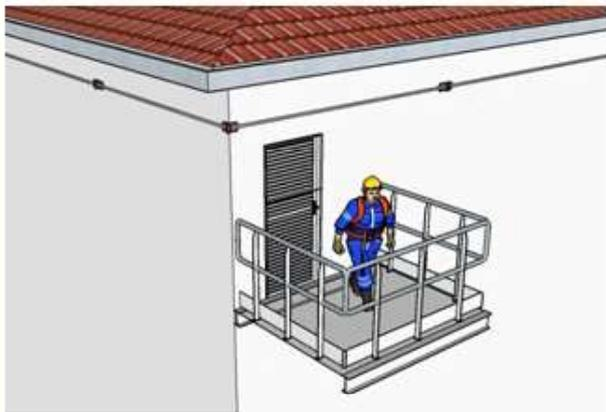
Colocação do sistema de ancoragem acima do sistema de cobertura (tubo na cumeeira do telhado), com acesso sem risco de queda;
