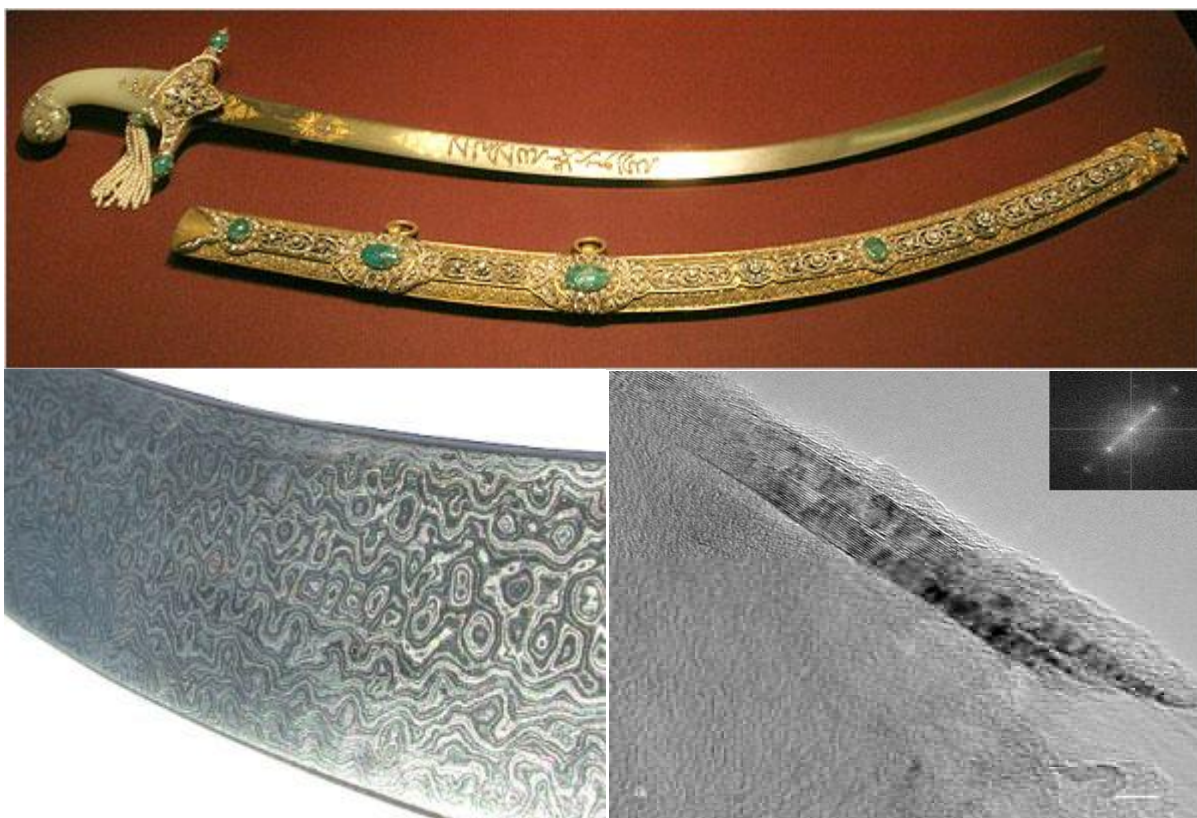
FIGURA 2 – ESPADA DE DAMASCO DO SÉC. VIII (ACIMA). FOTO APROXIMADA E IMAGEAMENTO POR MICROSCOPIA ELETRÔNICA (ABAIXO, ESQUERDA E DIREITA, RESPECTIVAMENTE) [4,5]
