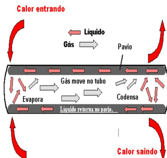
Figura 2.13: Diagrama ilustrando componentes e princípio de funcionamento de um *heat pipe* [68].
