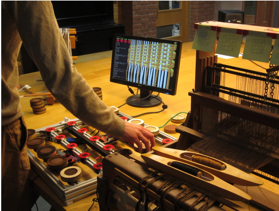
Figura 4 – Alex McLean manipulando uma Matriz de botões para tecelagem, conectado a um Raspberry Pi. Fonte: Griffiths (2015b).
