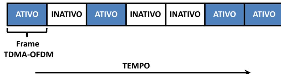
Figura 30 – Esquema de disponibilidade do canal PLC para comunicação de dados
