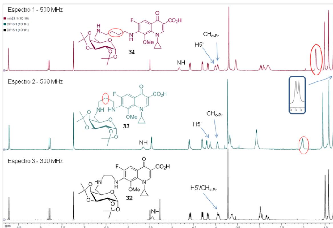
**Figura 20.** Superposição entre os espectros de RMN de  $^1H$  dos compostos **32**, **33** e **34**.
