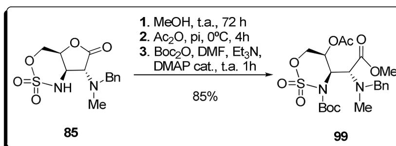
**Esquema 28.** Abertura da lactona, acetilação e proteção/ativação do grupo sulfamato.
