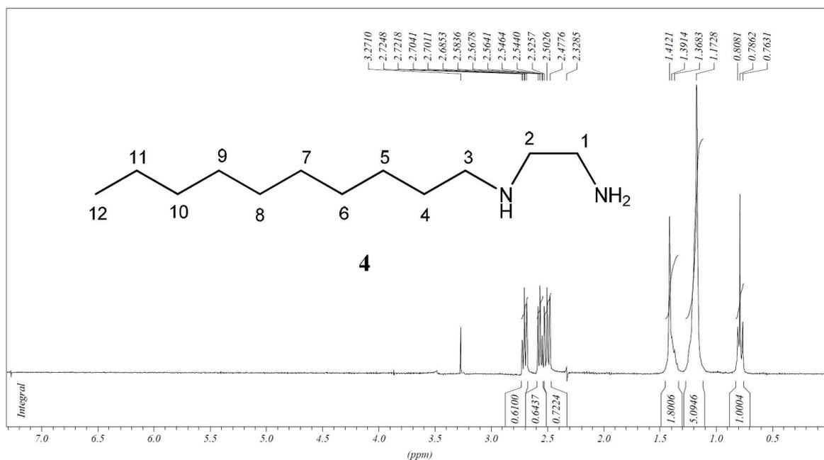
**Figura 10.** Espectro de RMN de  $^1\text{H}$  do composto **4** em  $\text{CDCl}_3$ , 300 MHz.
