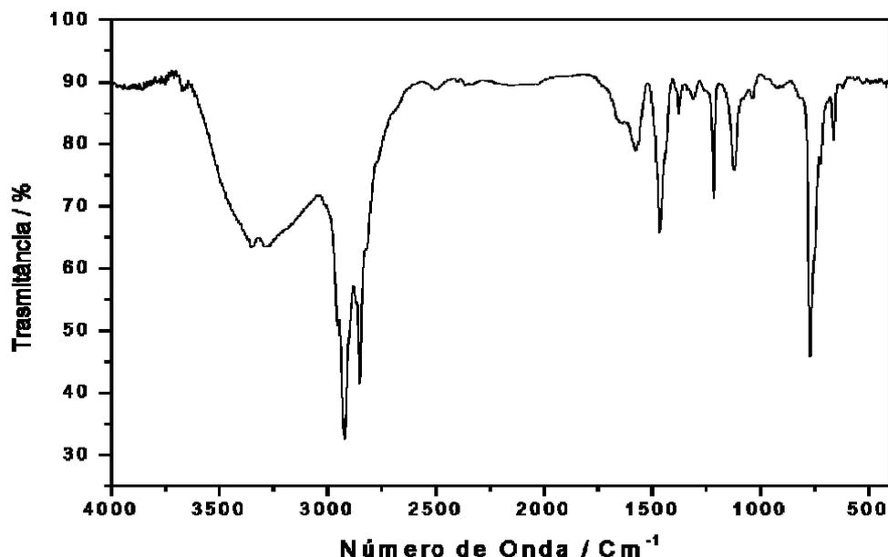
**Figura 9.** Espectro no infravermelho do composto **3** em Csl.
