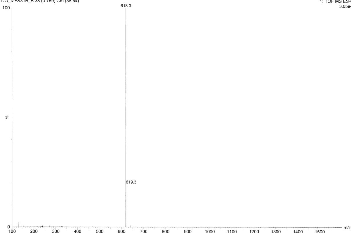
**Figura 27.** Espectro de massa (MS-ESI) do derivado (+)-**36**
