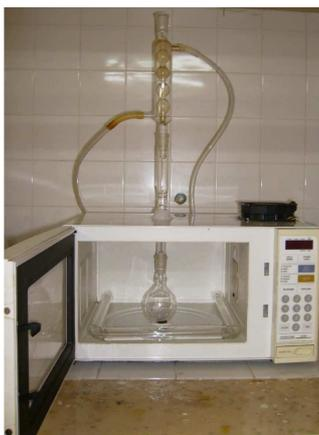
**Figura 21.** Aparelho de micro-ondas caseiro adaptado para síntese orgânica.
