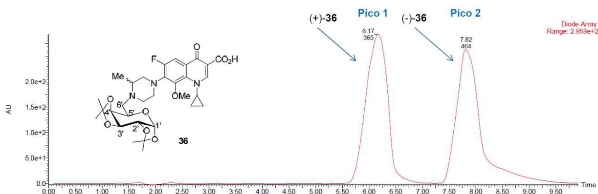
**Figura 26.** Cromatograma de CLAE da mistura ( $\pm$ ) **36**.
