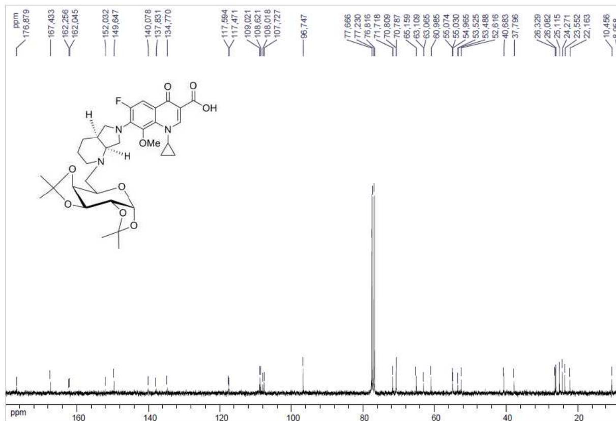
**Figura 30.** Espectro de RMN de  $^{13}\text{C}$  do composto **37** em  $\text{CDCl}_3$ , 75MHz.
