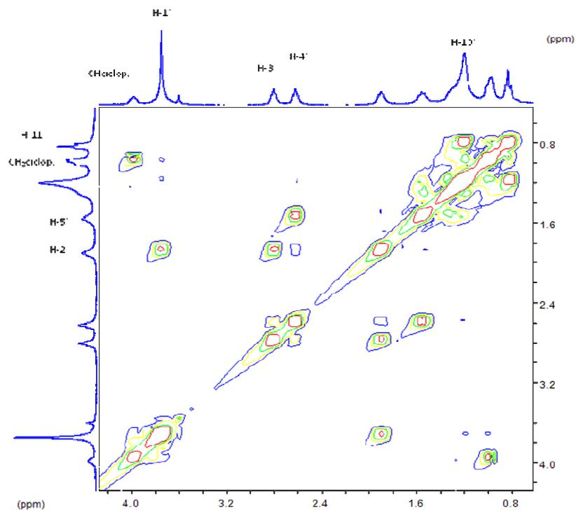
**Figura 18.** Seção expandida do mapa de contornos COSY do composto **22** em  $C_5D_5N$ , 300 MHz.
