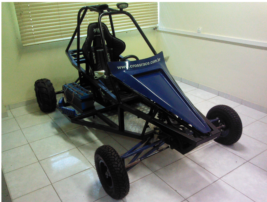
Figura 3: Fotografia do veículo elétrico de pequeno porte em desenvolvimento no laboratório da UFJF.
