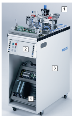
Figura 5: Estrutura da Estação MPS - (1) Planta, (2) Painel de Controle, (3) Gabinete Móvel, (4) Controlador
