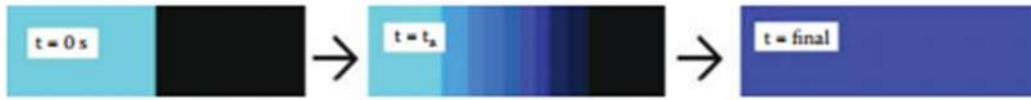
Figura 13: Etapas do processo de mistura de soluções. O processo de mistura homogeneiza os gradientes de concentração.
