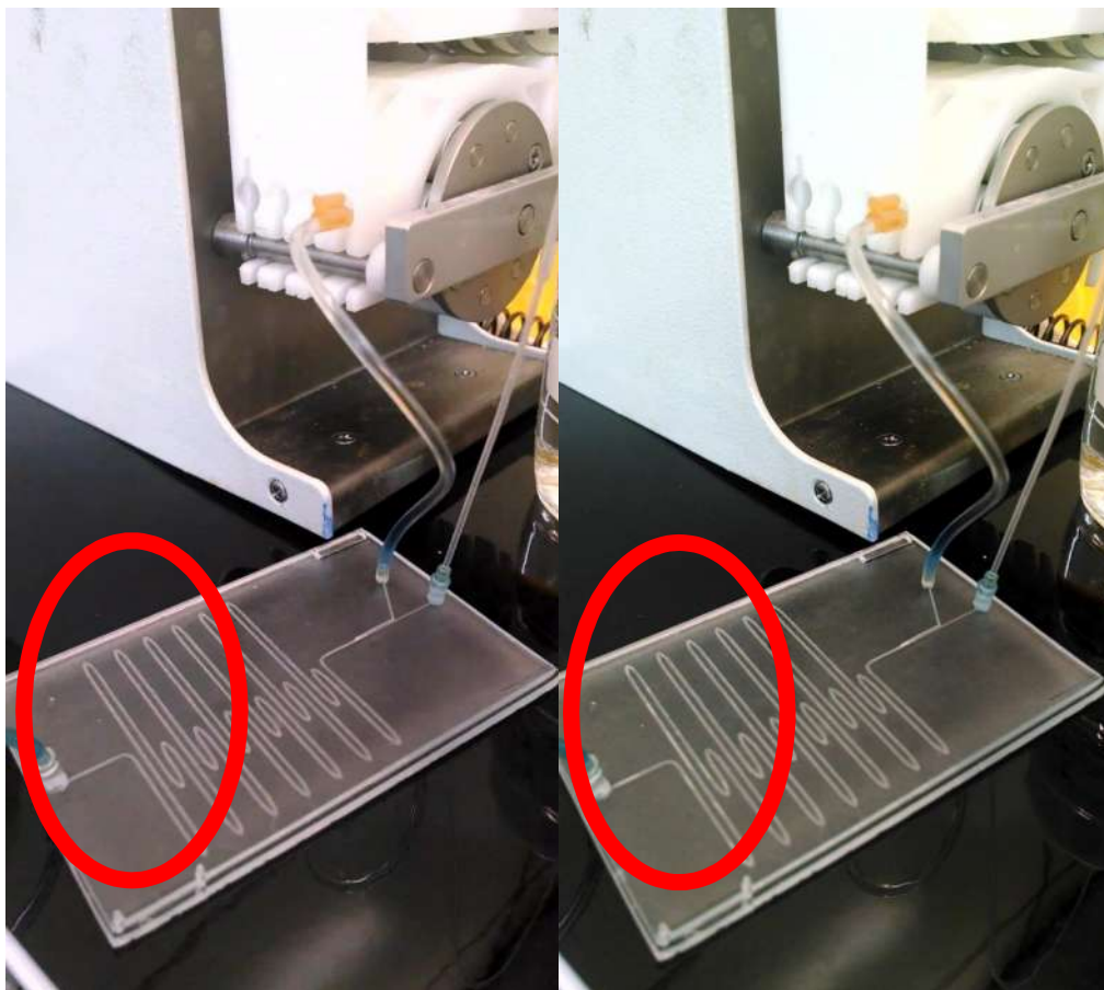
Figura 48: Evolução de O_2 na superfície do microreator decorrente da ação da CAT.
