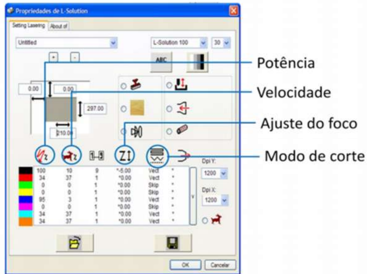
Figura 22: Parâmetros ajustáveis no equipamento de ablação a laser. Em destaque estão os principais ajustes da ablação para cada uma das cores associadas
