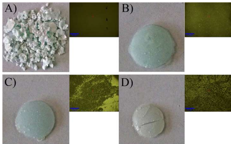
Figura 60: Aspecto físico e microscopia das diferentes misturas poliméricas estudadas. Relação %m:m utilizada no processo: A) 9 BADGE: 1 PEI, B) 7:BADGE: 3 PEI, C) 5: BADGE: 5: PEI e D) 3 BADGE: 7 PEI. A proporção 1 BADGE: 9 PEI não é apresentada devido à cura incompleta do material polimérico.
