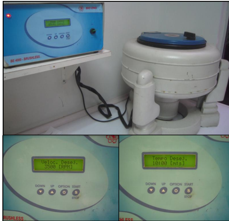
Fotografia 5 – Microcentrífuga com velocidade de 3500rpm utilizada por 10min. para decantação da saliva obtida pós-lavagem da moldagem.
