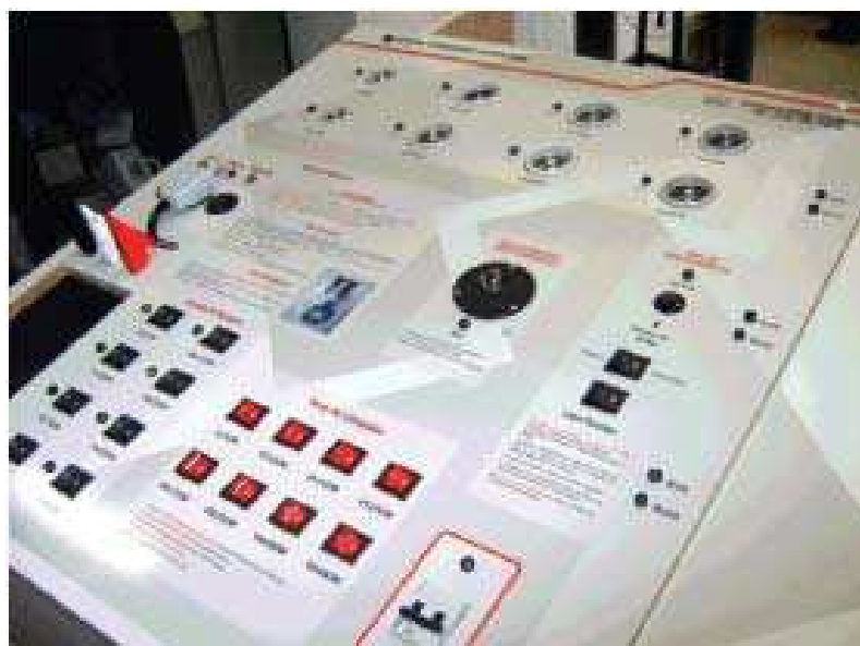
Figura 1.4 – Fotografia da bancada de testes de componentes de iluminação pública.
