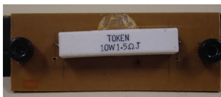
Figura 5.7 – Resistor utilizado para a medição de corrente em alta frequência.
