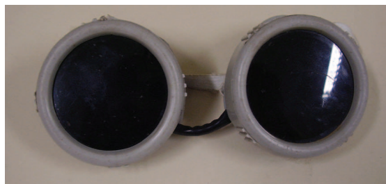
Figura 5.5 – Fotografia do óculos especial utilizado para a observação do arco de descarga.
