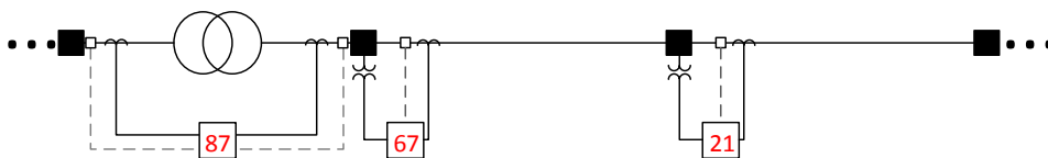
Figura 2.18: Alocação de equipamentos de proteção
