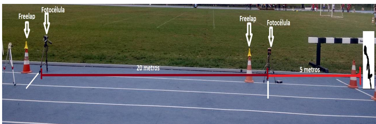
Figura 5: Disposição da célula fotoelétrica e do freelap no teste de corrida 20 m lançados.
