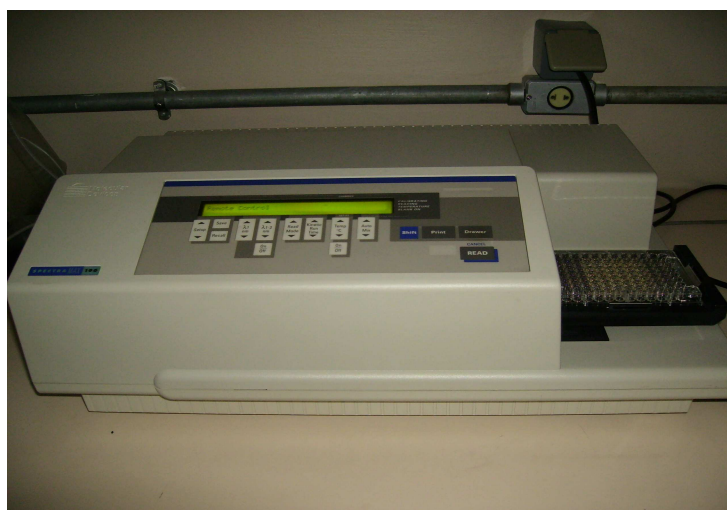
Figura 3.4. Leitor de microplacas Spectramax, utilizado no Método do MTT e no Método de Griess.
