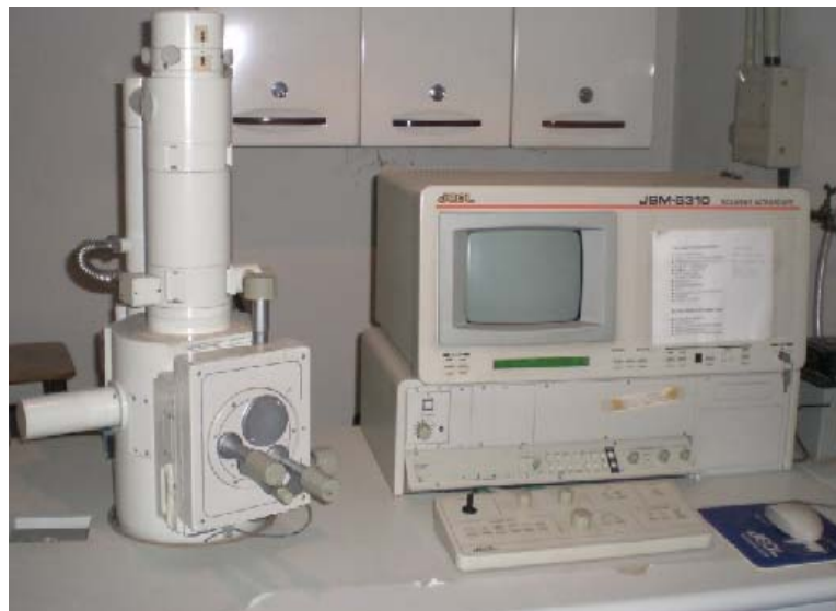
Figura 10 – Microscópio eletrônico de varredura utilizado para visualização das lamínulas no teste de aderência.
