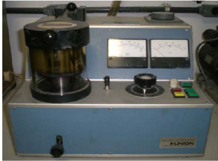
Figura 9 – Metalizadora utilizada para metalização das lamínulas no teste de aderência.
