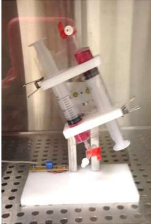
Figura 15 - Biorreator usando para recelularização dos folhetos processados.
