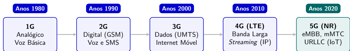
Figura 2 – Linha do tempo da evolução das gerações de redes móveis, evidenciando a transição de serviços focados em voz (1G/2G) para a hiperconectividade heterogênea do 5G.
