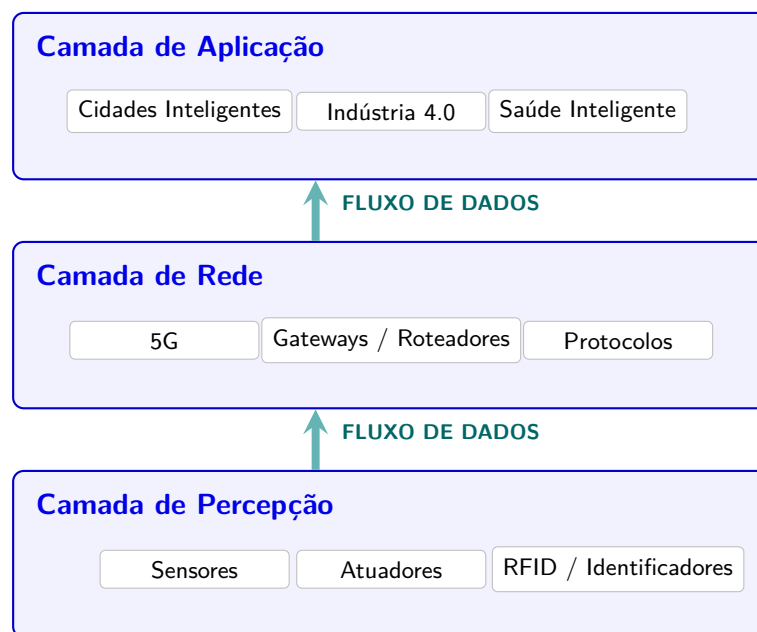
Figura 1 – Arquitetura de três camadas da IoT detalhando os domínios de percepção, rede e aplicação.
