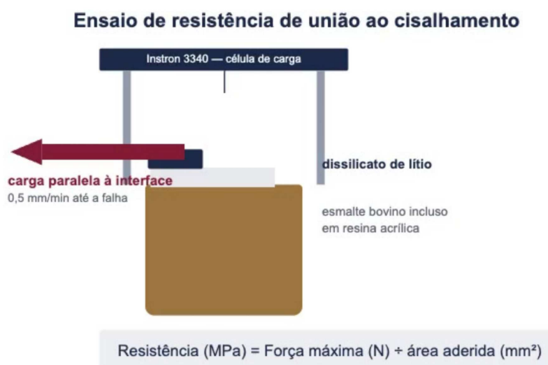
Figura 10 – Representação esquemática do ensaio de resistência de união ao cisalhamento
