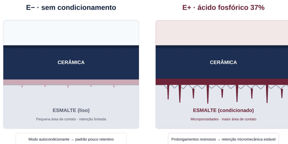
Figura 2 – Representação esquemática da interface adesiva sobre o esmalte sem condicionamento (E-) e condicionado com ácido fosfórico a 37% (E+)
