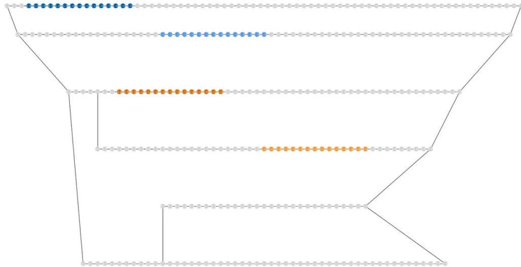
Figura 5.2: Quadro da animação gerada pela ferramenta auxiliar de visualização, mostrando as linhas do pátio (fileiras de trechos) e os blocos de vagões posicionados, cada um com cor distinta.
