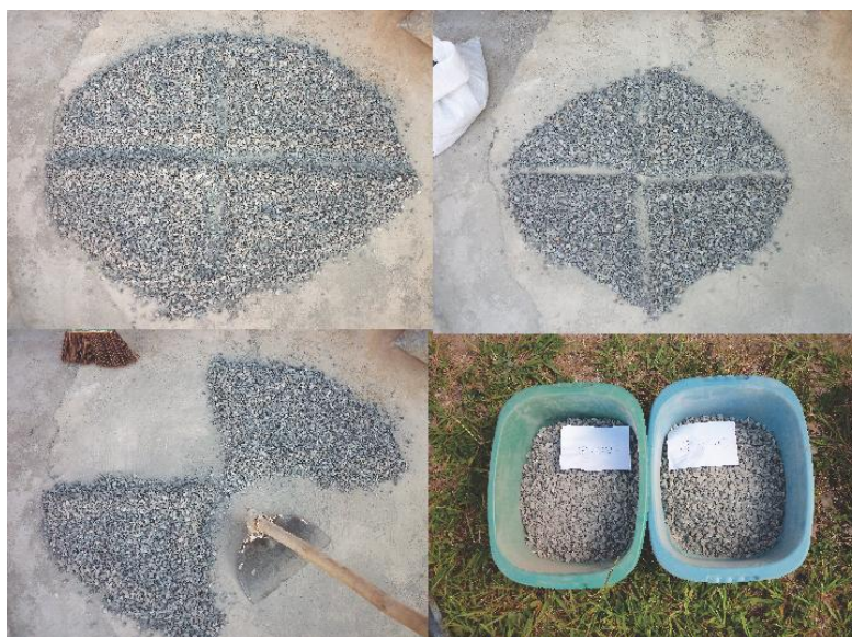
Figura 36– Quarteamento de amostras de agregados para a realização de ensaios
