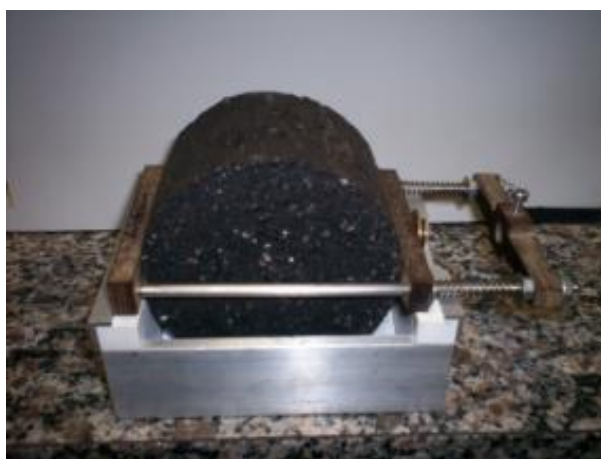
Figura 17– Montagem do suporte do LVDT (GENELHU, 2009)
