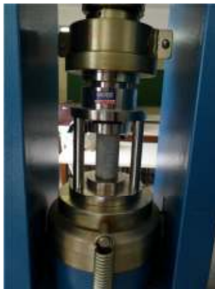
FIGURA 3. 6 – Ensaio de resistência à compressão axial
