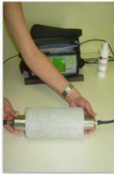
FIGURA 3. 15 – Ensaio de avaliação da velocidade de propagação de onda ultrassônica.
