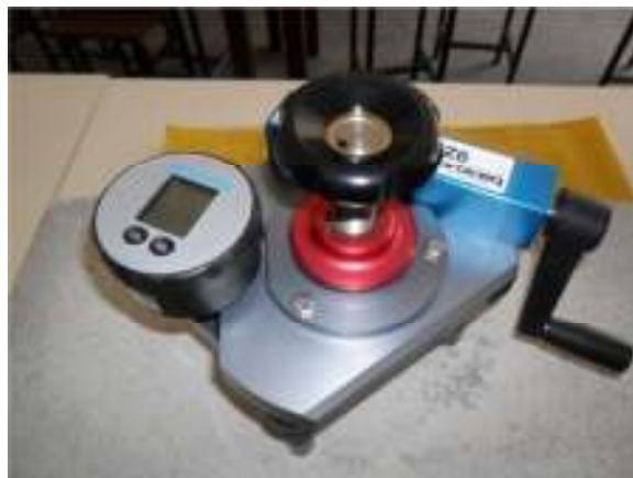
FIGURA 3. 10 – Ensaio de determinação da resistência ao arrancamento
