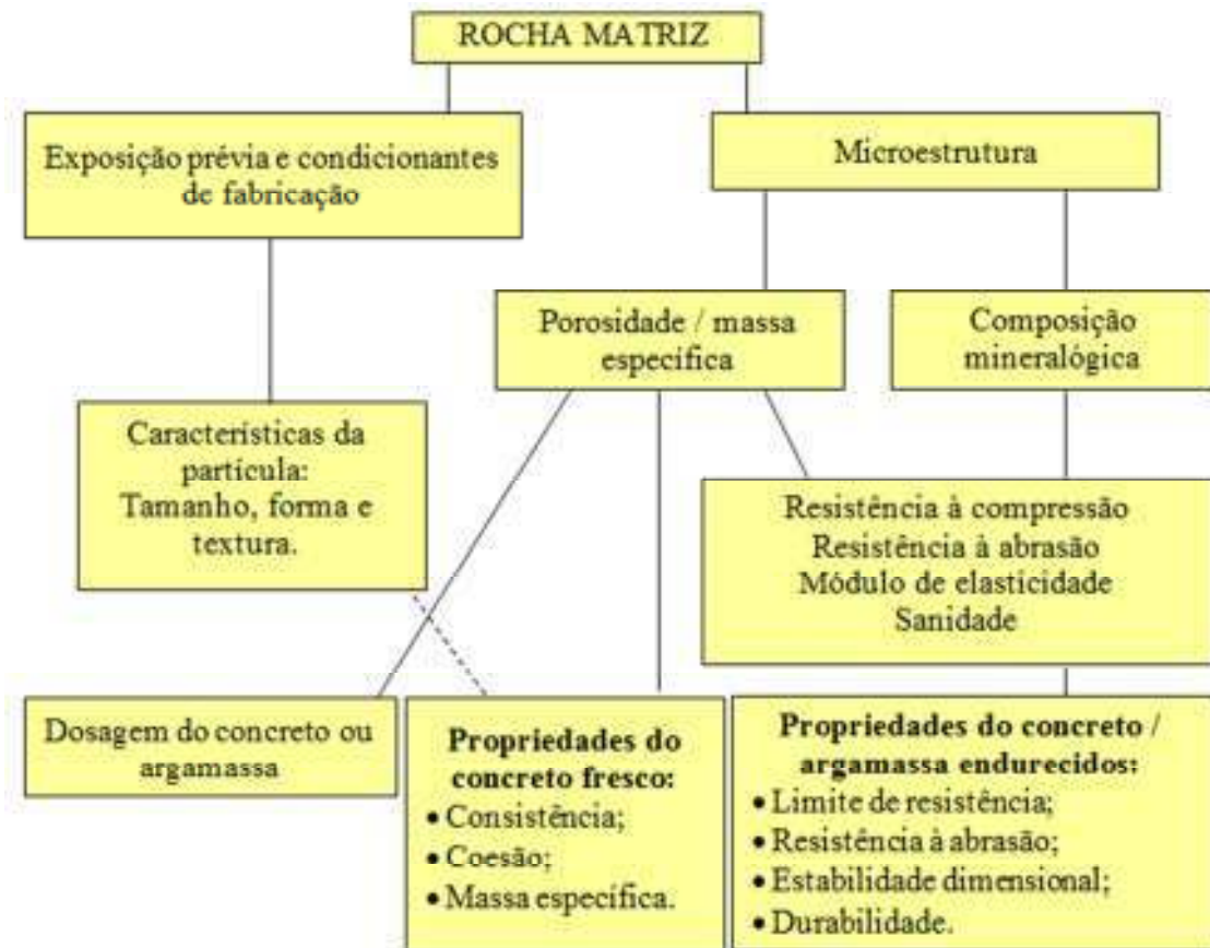
FIGURA 2.5 – Diagrama ilustrativo das várias inter-relações (adaptado de MEHTA & MONTEIRO, 2008).
