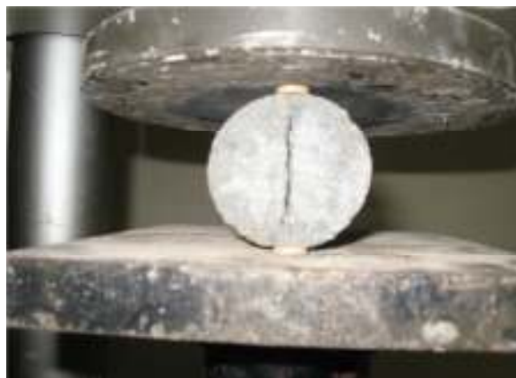
FIGURA 3. 7 – Ensaio de resistência à tração por compressão diametral
