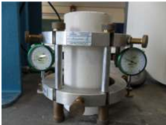
FIGURA 3.8 – Instrumentação para o ensaio de módulo de elasticidade
