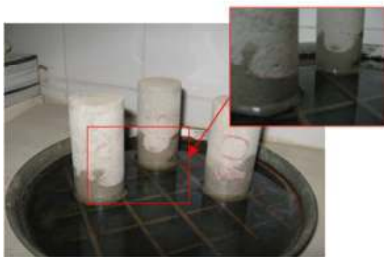
FIGURA 3.11 – Ensaio de absorção de água por capilaridade
