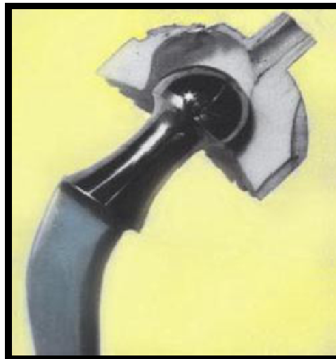
Figura 9. Desgaste de um acetábulo de teflon após 3 anos de uso com cabeça de 22 mm
