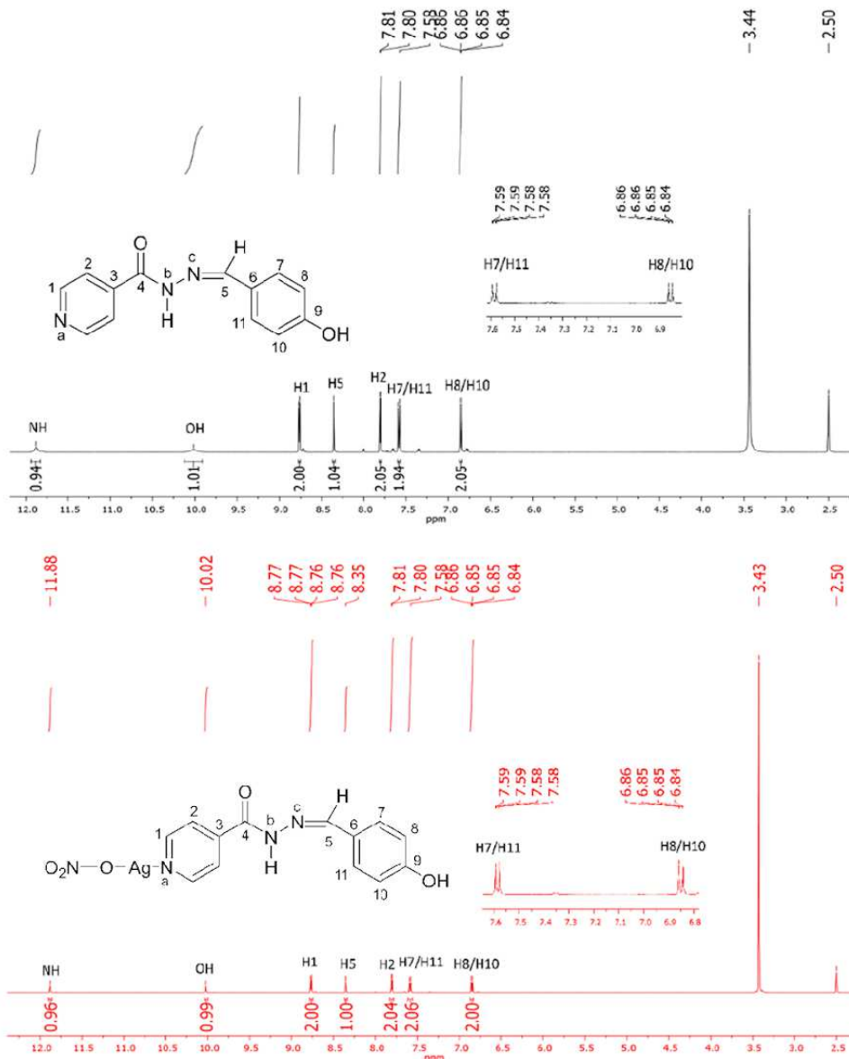
Figura 30 - Espectros de RMN de ^1\text{H} do IZpSAL e AgIZpSAL (DMSO- d_6 , 500MHz)
