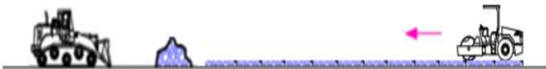
Figura 19 - Compactação do rejeito filtrado
