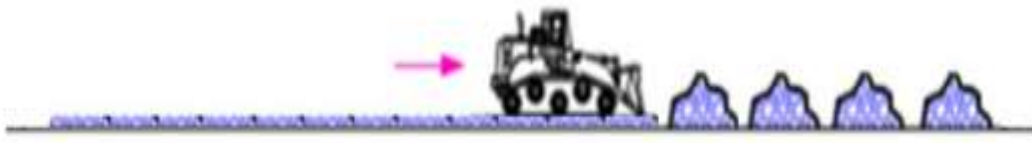
Figura 18 - Rejeitos filtrados espalhados por trator
