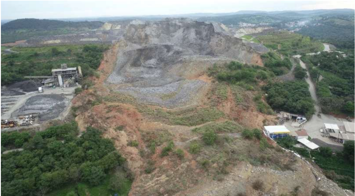
Figura 2 - Rompimento de pilha de rejeitos da empresa Jaguar Mining em 2024
