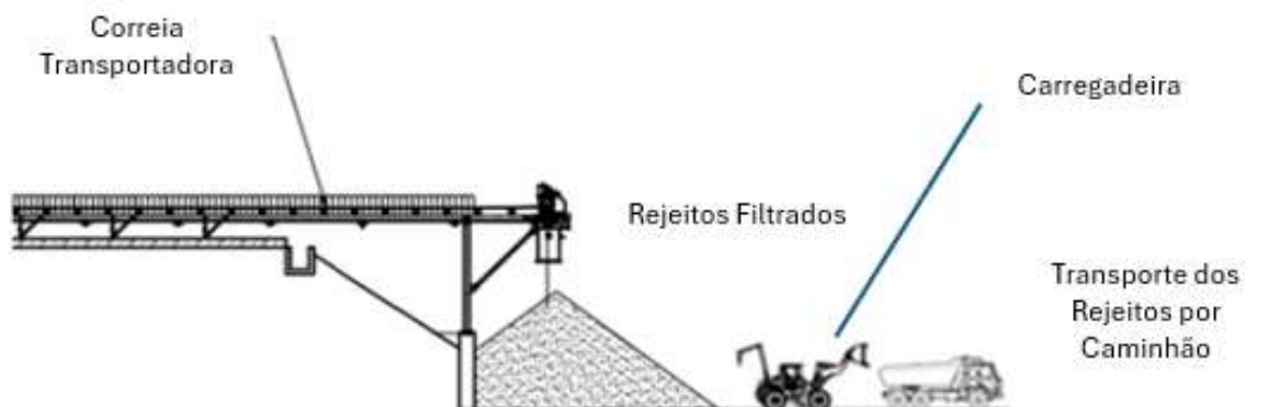
Figura 10 – Esquema de transporte de rejeito por caminhão
