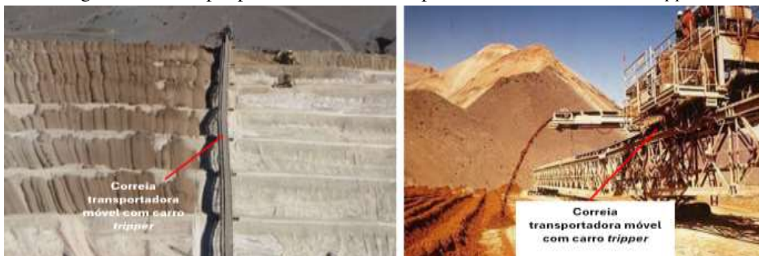
Figura 13 - Exemplo prático do uso de transportadora móvel com carro tripper
