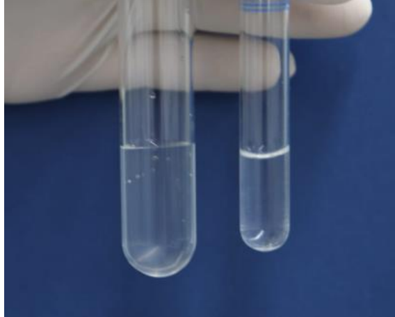
Figura 3 – Tubos com o inóculo antes e depois da padronização de turbidez de 0,5 McFarland
