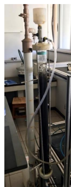
Figura 7: Amostra de lodo aeróbio no tubo durante a ozonização.
