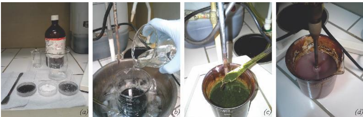
Figura 9 - Em (a) \text{H}_2\text{SO}_4 , \text{KMnO}_4 , \text{NaNO}_3 e grafite em flocos; em (b) reagentes em banho de gelo antes da adição de \text{KMnO}_4 ; (c) dispersão resultante após 24 h de oxidação e (d) dispersão após 120 h marcando o fim da primeira etapa de oxidação.
