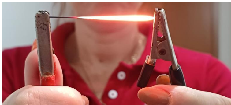
Figura 20 - Grafite ligado a uma fonte de tensão.
