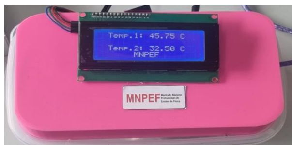
Figura 3 - Registro das temperaturas no display de LCD.
