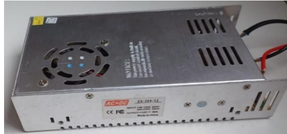
Figura 8 - Fonte chaveada de tensão.
