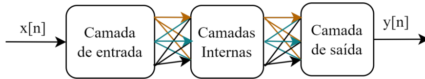
Figura 4 – Diagrama de Blocos do Mapeamento do Canal do Equalizador Não Linear Utilizando Multilayer Perceptron
