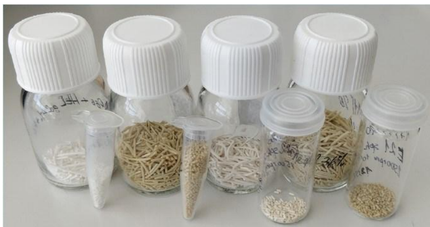
Figura 20 – Fotografia dos extrudados e grânulos obtidos a partir da moldagem da UiO-66(Zr) e UiO-66(Zr)-NH 2 com os aglutinantes quitosana e hidroxietilcelulose.
