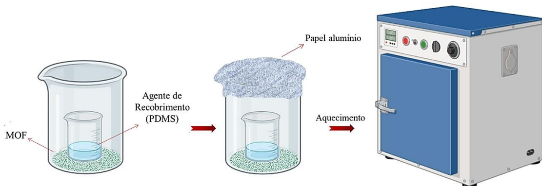
Figura 25 – Esquema ilustrativo do procedimento de obtenção de recobrimento hidrofóbico sobre a superfície do sólido por deposição do vapor de um agente de recobrimento.
