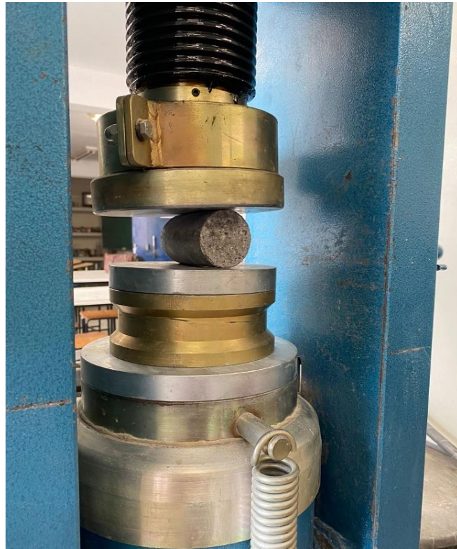
Imagem 13 - Ensaio de tração por compressão diametral.
