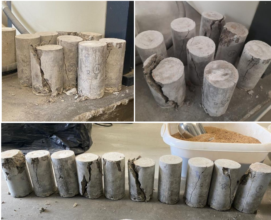
Imagem 12 – Pós ruptura dos corpos de prova por compressão axial.
