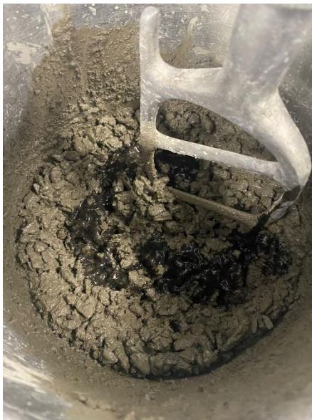
Imagem 8 - Inserção do CGO na mistura de concreto.
