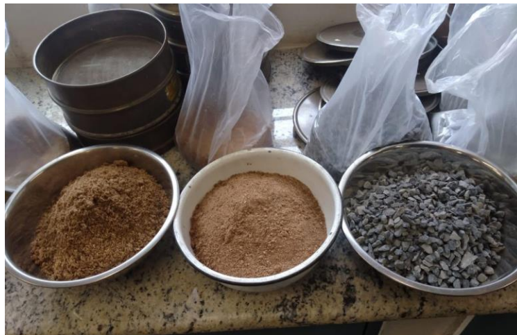
Imagem 7 - Organização dos materiais para virada do concreto.
