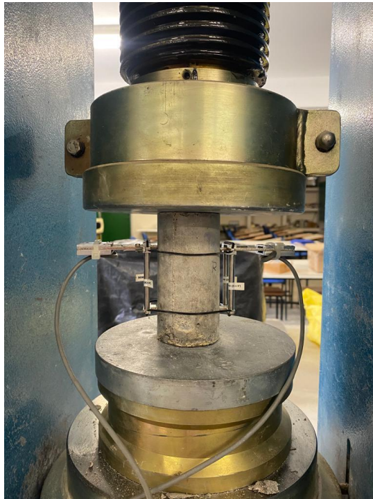
Imagem 14 - Execução ensaio de módulo de elasticidade estático.
