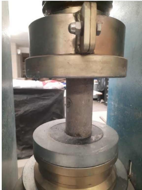
Imagem 11 - Ensaio de Resistência à Compressão Axial.
