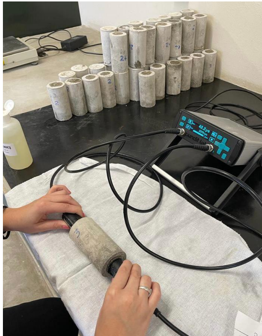
Imagem 10 - Execução ensaio de pulso ultrassônico.
