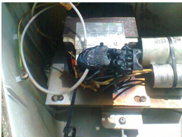
Figura 112 – Reator eletromagnético de uma das luminárias substituídas com detalhe do enrolamento queimado.
