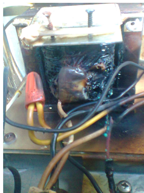
Figura 112 – Reator eletromagnético de uma das luminárias substituídas com detalhe do enrolamento queimado.
