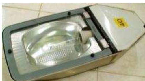
Figura 85 – Luminária com lâmpada vapor de sódio em alta pressão de 250 W e reator integrado.
