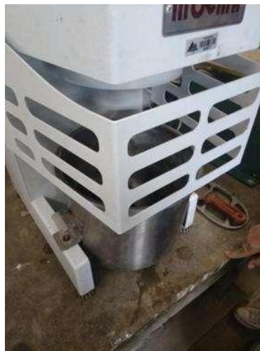
Figura 12 - Argamassadeira em funcionamento.
