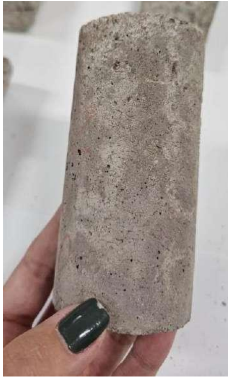
Figura 47 - Corpo de prova 0,02% de CGO exposto à temperatura de 600°C.
