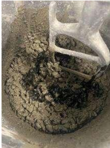
Figura 14 - CGO sendo incorporado ao concreto.
