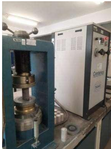
Figura 18 - Início do ensaio de resistência à compressão axial.
