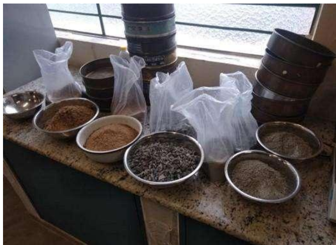
Figura 11 - Separação dos materiais para a produção dos concretos.
