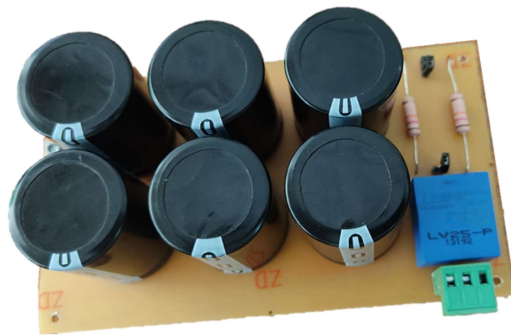
(b) Banco de capacitores confeccionado
