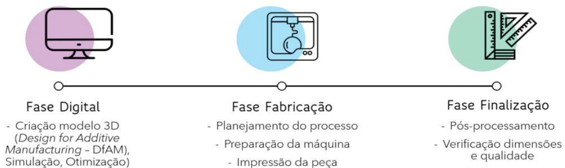
Figura 4 - Processo simplificado da manufatura aditiva
