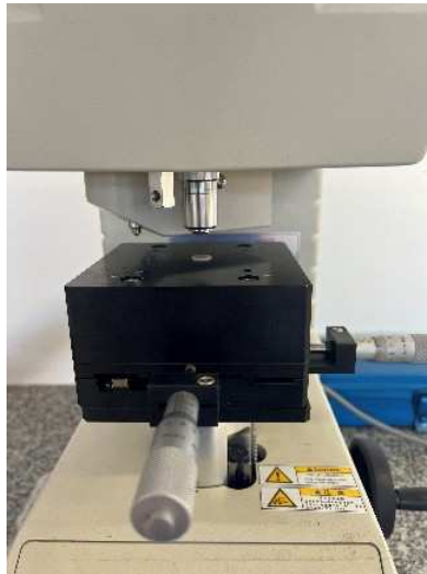
Figura 7: Amostra cerâmica posicionada no microdurômetro
