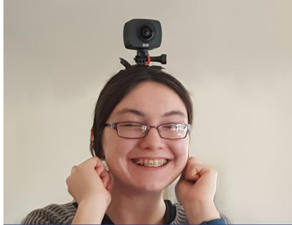
Figura 9 - montagem de câmera de ação 360° na cabeça
