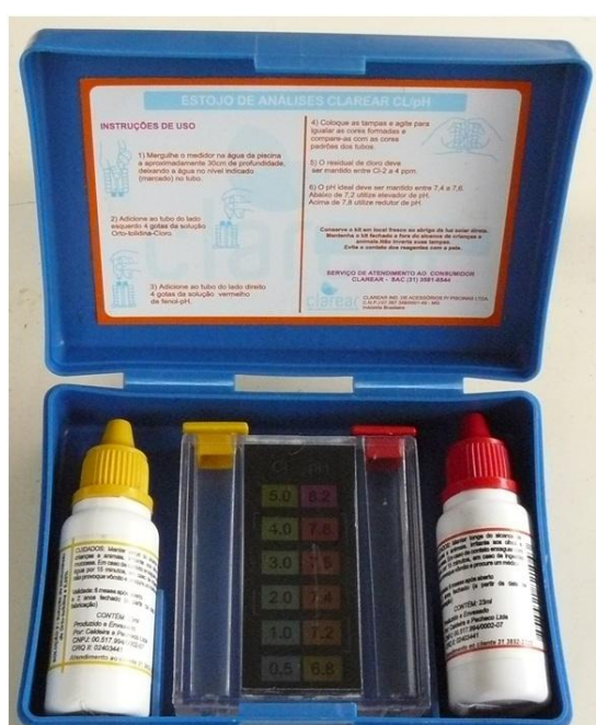
Imagem do estojo com o kit portátil de medição de cloro e pH na água.
