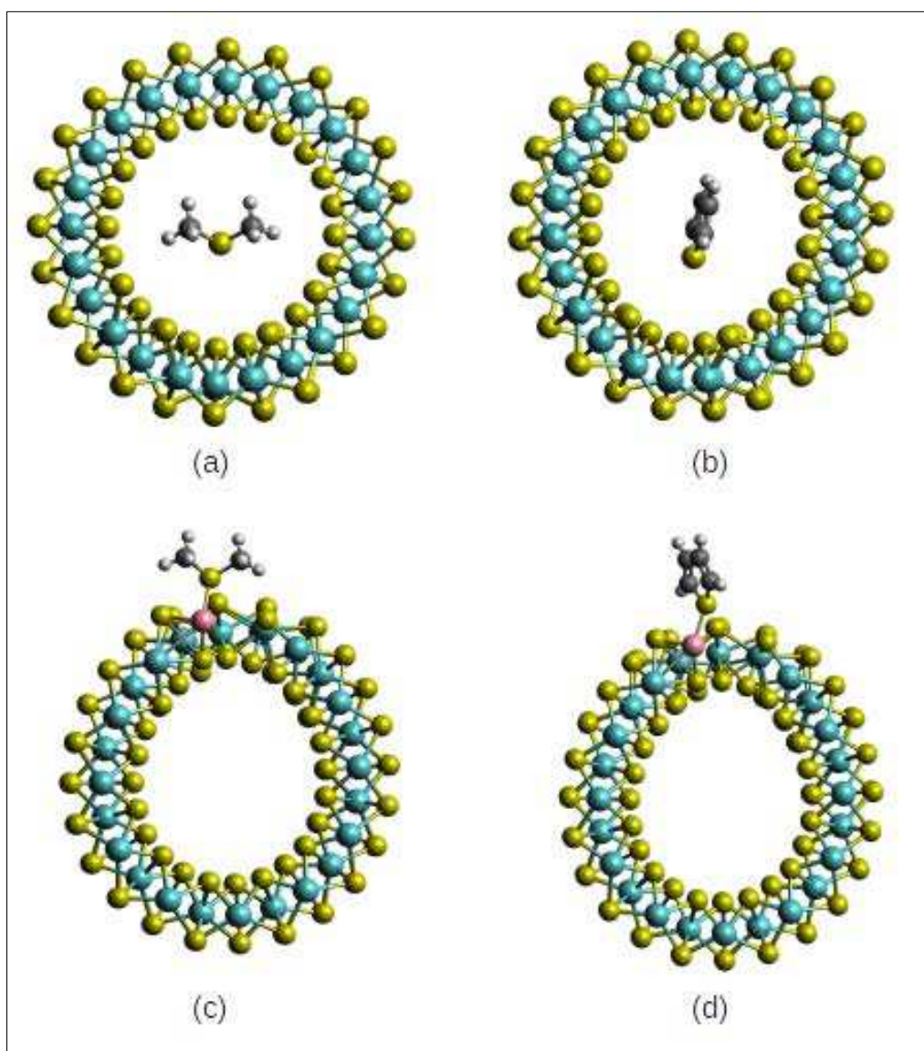
Figura 23 – Adsorção de moléculas nas estruturas: (a) NT vacância interna /dimetil sulfeto, (b) NT vacância interna //tiofeno, (c) NT-Co vacância /dimetil sulfeto e (d) NT-Co vacância /tiofeno
