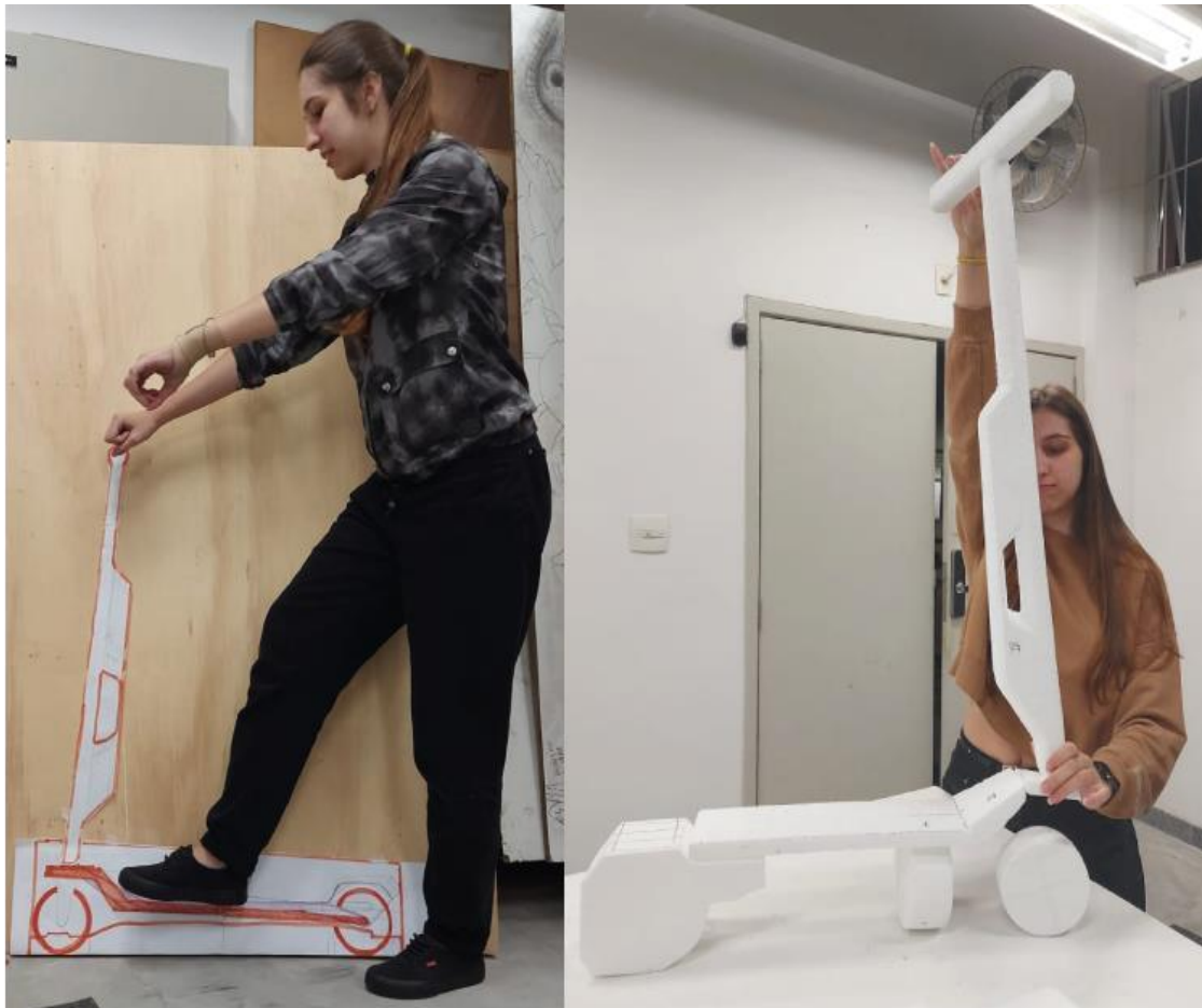
Figura 11 – Avaliação em escala 1:1 da alternativa final em representação bidimensional e definições em modelo físico tridimensional 1:1.
