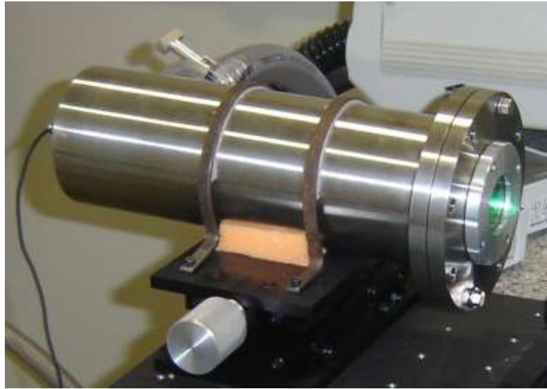
Figura 3: Câmara da técnica pc utilizada para encontrar a capacidade térmica volumétrica da amostra.
