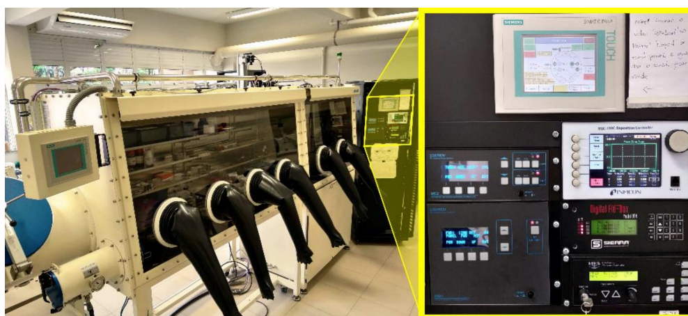
Figura 7. Glovebox e câmara de deposição no LEO com detalhe para a interface de controle.
