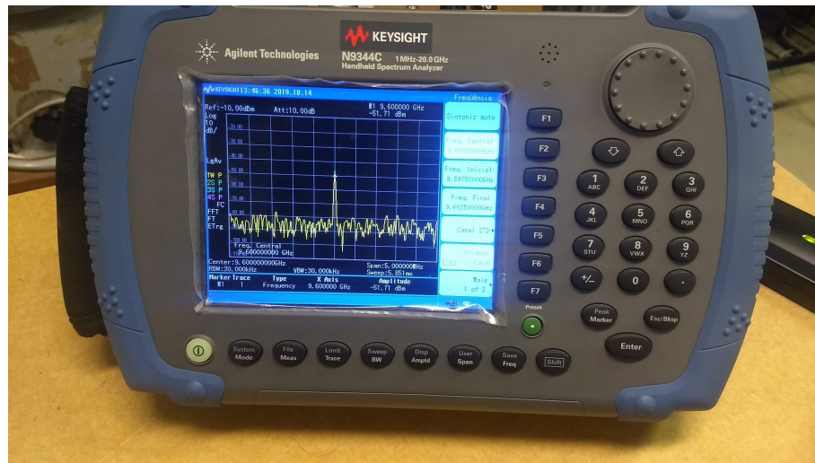
Figura 20 – Analisador de espectro também da Keysight/Agilent, Handheld Spectrum Analyzer N9344C
