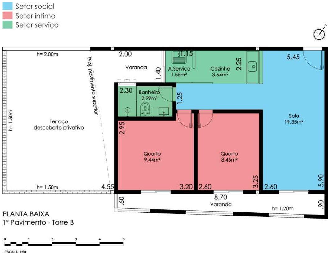
Figura 11 – Planta baixa e Setorização do Green Tower (2017).
